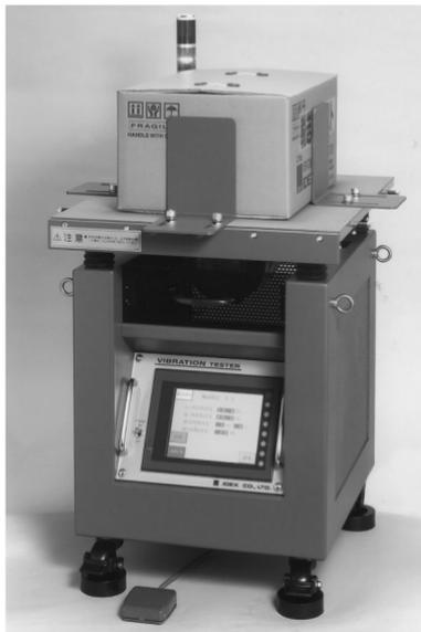
貨物に上下・左右・前後の3軸同時振動を与え、輸送時の損傷を再現・検証する輸送梱包試験機。
