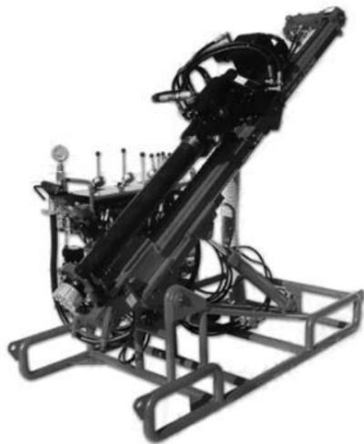
高所・狭所でのロックボルト工法や法面工事に最適な超小型・軽量・高性能のスプリングドリル。油圧モーターの回転力で2枚の羽根状の構造をしたカムシャフトが回転、関連するハンマーが後方に押し下げられる。このハンマー内部に大小2本のスプリングが収められており、圧縮する方向にスプリングが押し下げられるため、所定の位置でカムシャフトから開放されると同時に、ハンマー自重とスプリング圧縮の反動力により打撃エネルギーが発生する。発生した打撃エネルギーはロッドを介して先端にあるビットに伝達され、岩盤などの対象物を破壊しながら削孔する仕組み。
