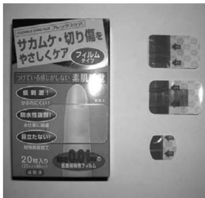
さかむけ・あかぎれの保護を目的とした救急絆創膏。厚さ 0.01mm と極薄のポリウレタン製フィルムを救急絆創膏に初めて採用した。0.01mm 厚のポリウレタンフィルムは極薄でコシがなく、やわらかいためフィルム単独での救急絆創膏への加工が難しく、また貼りにくい。そのため救急絆創膏として使用することが困難であった。これを、フィルムにもともと付属しているポリプロピレン製キャリアをそのまま製品に利用する独自のアプリケーション（操作性を向上させるための製品形状や構造の工夫）・製法を考案することで容易な加工を実現した。
