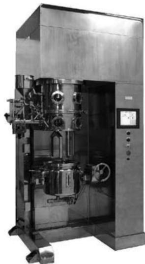
水難溶性の薬品を飲みやすい顆粒状に成形する製剤用の混練造粒機。攪拌機構は、トップドライブ方式で遊星運動というユニークな構造。デッドスペースのない攪拌軌道で造粒するため、付着のない状態で水難溶性・付着性を示す薬物の造粒を短時間、高歩留まりで処理できる。
