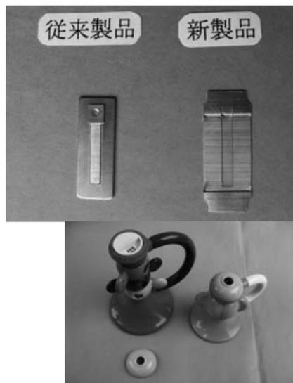
ハーモニカが生まれて約 200 年。音源となるリードプレート (R/P) の製造方法は、ほとんど変わらない。リードとプレートの 2 つの部品を別々にプレス加工し、組み付ける製造工程は、約 0.05mm 寸法差の中でリベット打ちや、スポット溶接により組み立て、調整工程を経て調律工程に入り音を合わせる方法だった。
