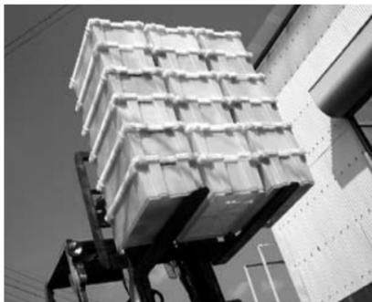
スナップ式のユニークな結合機構を採用したプラスチックコンテナボックス。ボックス側面の傾斜した台形状のスナップヒット機構により、ボックスが連結して固定される。上下にも抜け落ちにくいいため、フィルムやバンドなどを使用せずに連結したままで輸送ができる。運搬・地震・接触などによる振動や衝撃でも倒壊しにくく、一体成形で連結子部品などを一切使っていないため、連結作業の面倒や故障がない。材質は柔軟性のあるPE樹脂を採用。このため、連結部に重量負担がかかっても破損しにくい。
