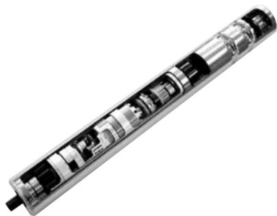
ローラーコンベアの駆動ローラーやベルトコンベアの駆動プーリーとしても使用できるモーターローラー。回転するローラーパイプ内にDC24Vのブラシレスモーターを収納し、モーターの出力を一旦遊星歯車減速機構で減速・増力してローラーパイプに伝える構造。モーターを駆動するドライバー回路も2枚の基板に分け、ローラーパイプ内にコンパクトに収納されている。
