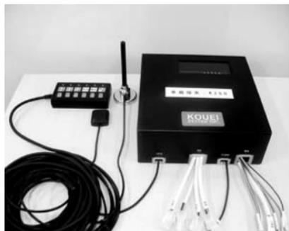
個別トラックごとのエコドライブを可能にする次世代車載端末。CAN-BUSよりデータを取得することで、すべてのトラックメーカーの車両の燃料使用量が計測でき、トラック輸送において燃料費の削減とCO<sub>2</sub>の削減が実現できる。
