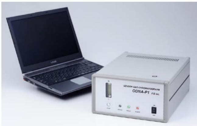
微量ガスを計測するガスクロマトグラフタイプのポータブルガス計測器。カラムを小型化し、検出器に高感度の半導体ガスセンサーを使用して高感度化を実現するとともに、キャリアガスに大気 of 空気を使用することでキャリアガスポンベを必要としない構成とし、機器の小型化（B4サイズ、5.5 k g）を達成。研究室だけでなく、計測現場に持ち込むこともできる。
