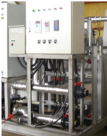
大気中から窒素ガスを抽出し、その窒素ガスを水中に注入し、窒素ガス圧を高めて酸素を追い出し窒素氷を造るシステム。真水や海水からブロック氷やシャーベット氷、フレーク氷が製造できる。
